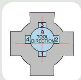
Multi - keyway 多槽等角度插削
